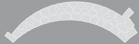
Ein Kurvenkeil erzeugt eine Verschwenkung um 9,5 Grad.
